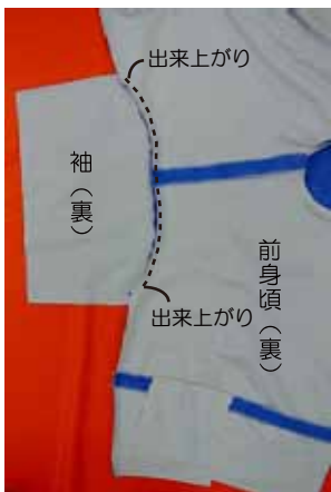
⑦ 袖を付ける 身頃と袖を中表に合わせ出来上がりまで縫う (両側)
