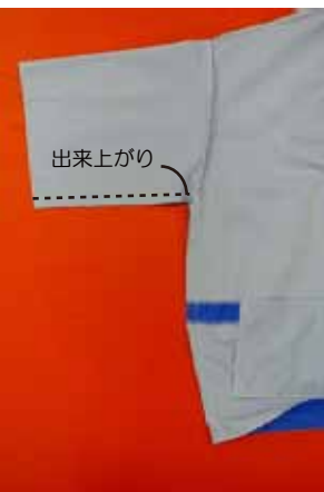
⑧ 脇を縫う ⑧-1 前後身頃を中表に合わせ袖下を縫う (袖付け側は出来上がりまで)
