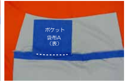
②-3 ポケット袋布Aを裾側に倒し、口にステッチする
