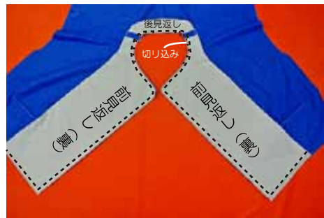
⑥ 身頃と見返しを縫う ⑥-1 身頃と見返しを中表に合わせ縫う (衿ぐりの縫代に切り込みを入れる)
