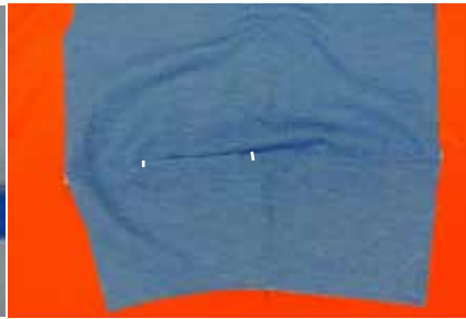
②-6 ポケット口の両脇に表からステッチする (ポケット口補強の為)
