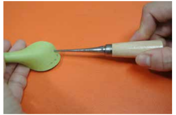
穴が小さいと針を通しにくいので、目打ちなどで大きくしておく
