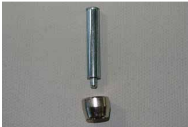
① 穴をあける ①-1 打ち棒に穴あけパーツをセットする
